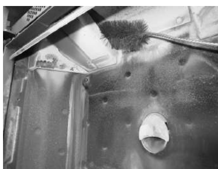
Fig. 40 - Reiniging met pijpenrager
