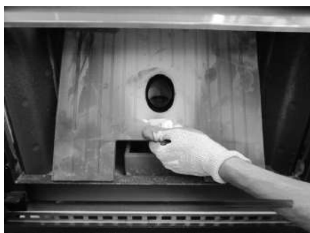
Fig. 39 - Verwijder de gietijzeren centrale wand
