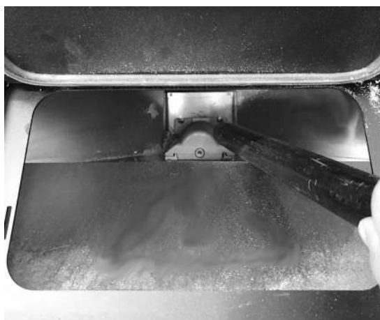
Fig. 35 - Reiniging van de voorraadbak
