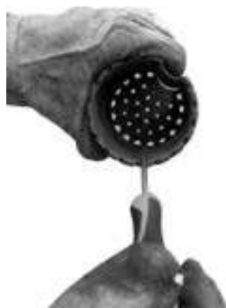
Fig. 34 - het schoonmaken van de vuurpot
