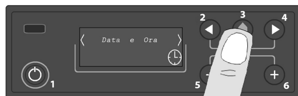
Fig. 5 - In der Status-Startbildschirm drücken Sie die Taste 3, um das Menü aufzurufen.
