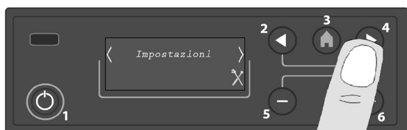
Fig. 6 - Faire défiler avec la touche 4 jusqu'à ce que l'inscription « Impostazioni » (Configurations) apparaisse.
