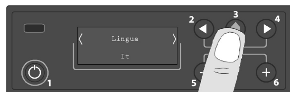
Fig. 7 - Confirmar com o botão 3 para aceder ao submenu de definições.
