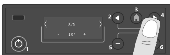
Fig. 10 - Legen Sie mit Taste 4 die gewünschten Flammenerhaltungsminuten fest.
