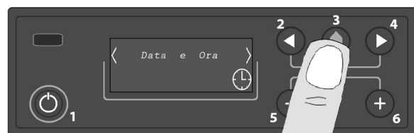
Fig. 5 - Dalla stato iniziale premere il tasto 3 per entrare nel menu.
