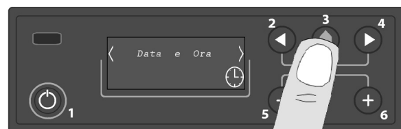
Fig. 5 - A partir do estado inicial, prima o botão 3 para aceder ao menu.
