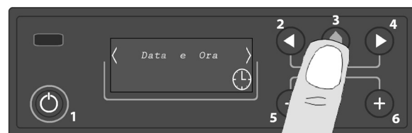
Fig. 5 - Druk vanuit de beginstand op knop 3 om het menu te openen.
