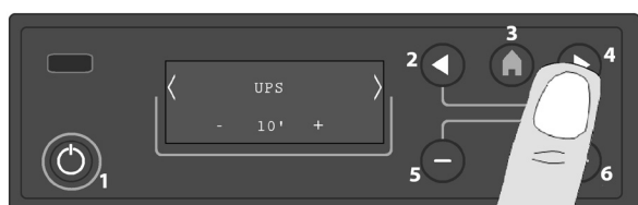
Fig. 10 - Utilice la tecla 4 para determinar los minutos de mantenimiento de llama deseados.
