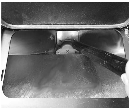
Fig. 22 - Reiniging van de voorraadbak en transportschroef
