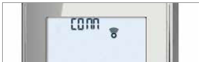
Figure 1: Synchronisation en cours
