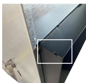
Schuif de bovenlat zodanig dat de haken in elkaar schuiven.
