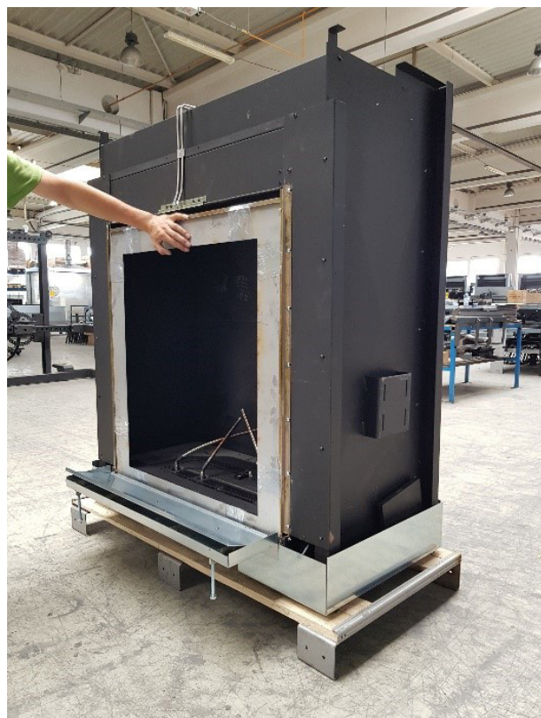
Bij het openen van de deur begint kantelplaat te kantelen
