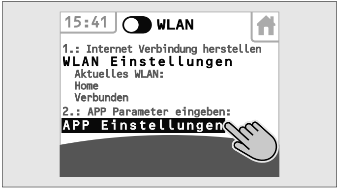
Abb. 3.45 Bei bestehender WLAN Verbindung App Einstellungen wählen
