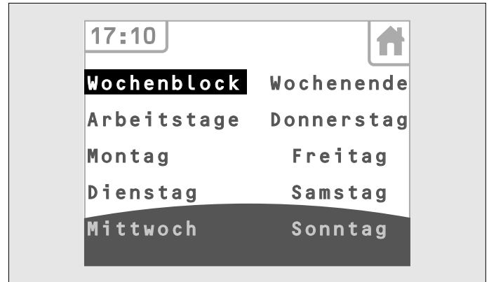
Abb. 3.24 Touch-Bedienfeld – Schaltzeiten, vordefinierte Tagesblöcke
