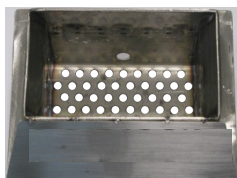
Schone verbrandingspot met alle gaatjes en openingen goed zichtbaar
