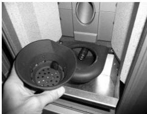
Figuur 10 - Reiniging branderkorf en onderliggende ruimte
