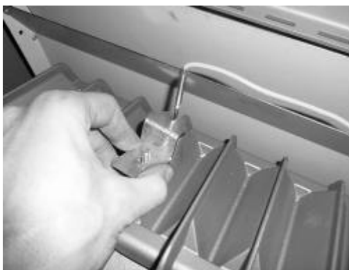
Figuur 11 - Demontage vlamvoeler
