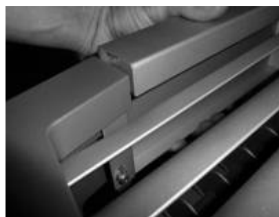
Figuur 2 - losmaken van het bovenste frontpaneel
