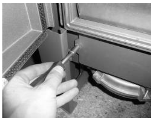
Figuur 14 - Demontage reinigingsdeksel
