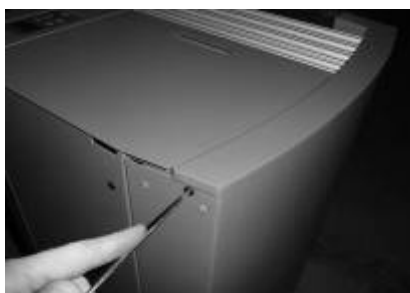
Figuur 7 - los de bevestigingsschroeven
