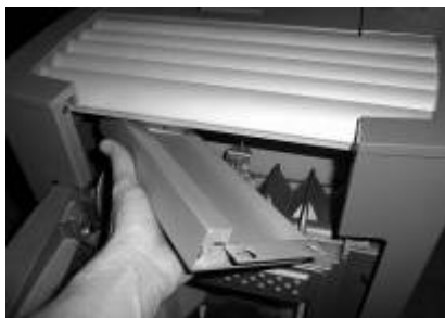
Figuur 4 – draaien en uitnemen van de bovenste frontbekleding
